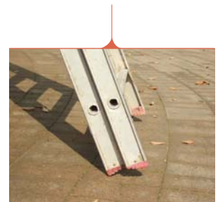
이동식 사다리 하부 미끄럼방지 장치(접은 상태로 일자로 설치 시)
